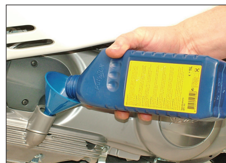
8 もしレベルが低い場合は、推奨されたグレードおよび種類のオイルでレベルをほぼMAXラインまで上げてください。過度に注入しないでください。
