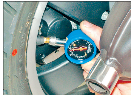
2 タイヤの圧力は、タイヤが冷えているときに確認してください。
