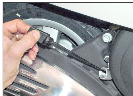
3 そして2012年以降のSprintおよびPrimavera 3vモデルでは、エンジンの右側からオイルフィルターキャップ/レベルディップスティックを外してください。
