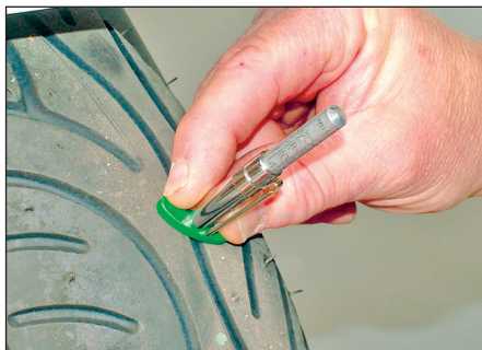
3 トレッドの深さは、トレッド深さ計を使用してタイヤの中央で測定してください
