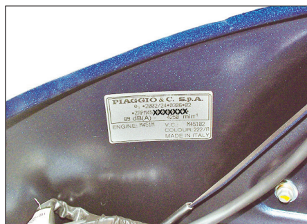
フレーム番号は、カラーコードのラベルに表示されています。
