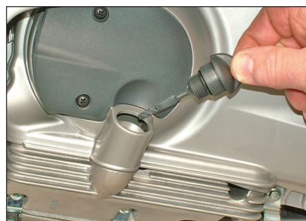
6 ディップスティックを挿入してキャップを完全に締め込んでください。
